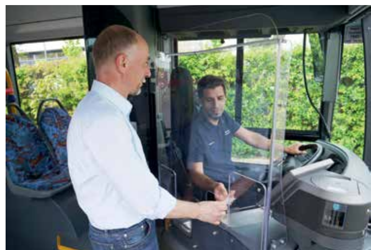
Mercedes-Benz Citaro C2 mit nachgerüsteter Fahrerschutzscheibe aus Polycarbonat
